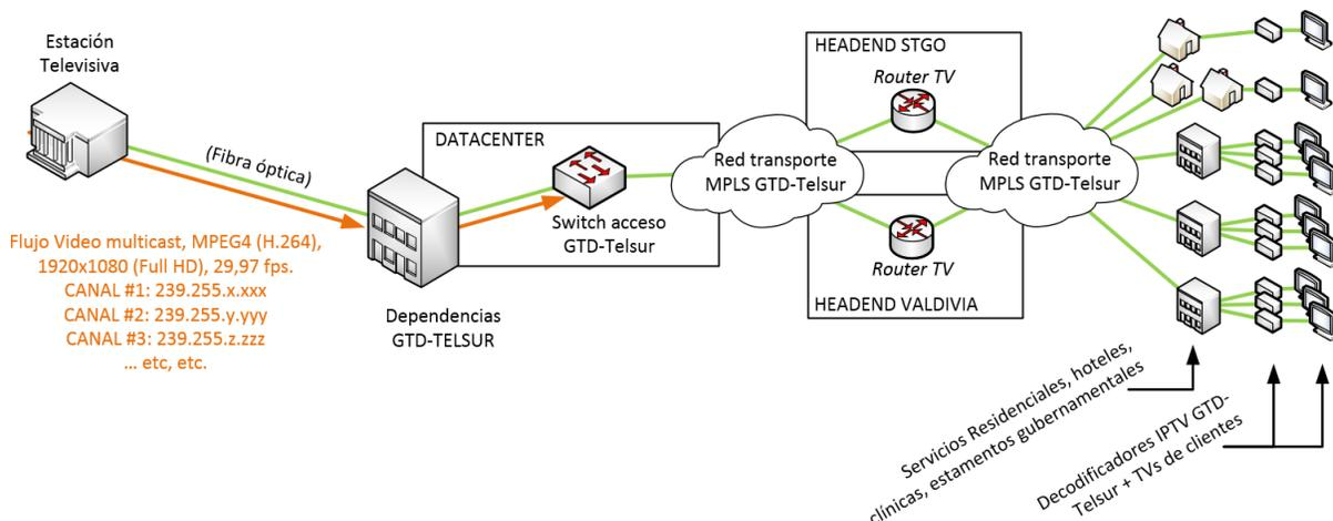
**(b.) Solución con instalación de Encoder en dependencias del Proveedor de Contenido.**
